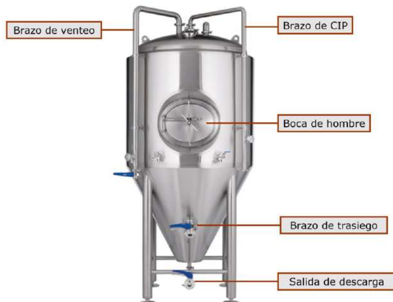
Figura 3. Fermentador con brazo de CIP y venteo separados. Recuperado y adaptado de www.kegland.com.au
